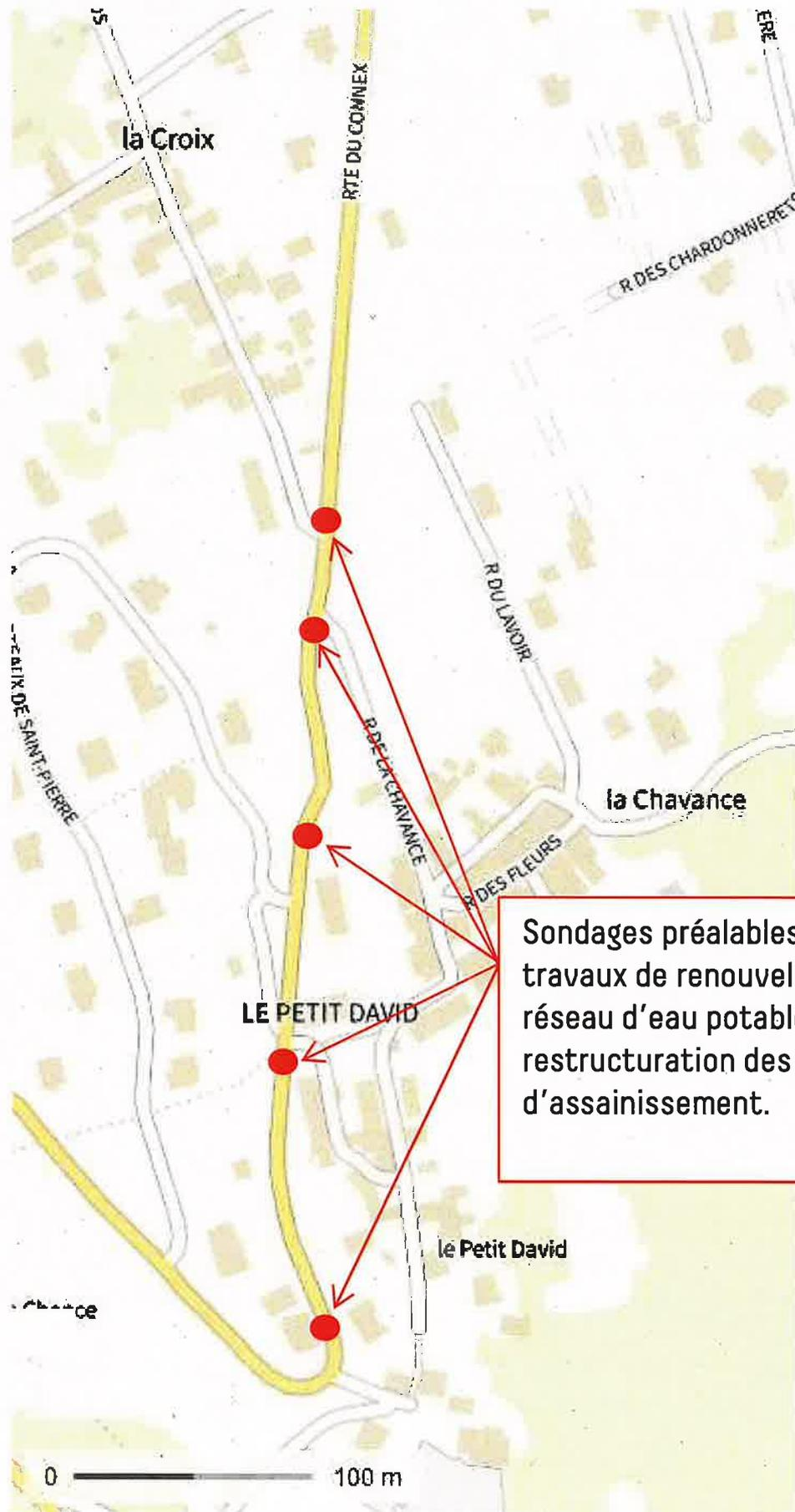
Sondages préalables à des travaux de renouvellement du réseau d'eau potable et de restructuration des réseaux d'assainissement.
